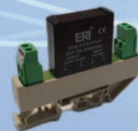
Oddělovací relé pro převod aktivního impulzního výstupu průtokoměru F4022 na pasivní.
